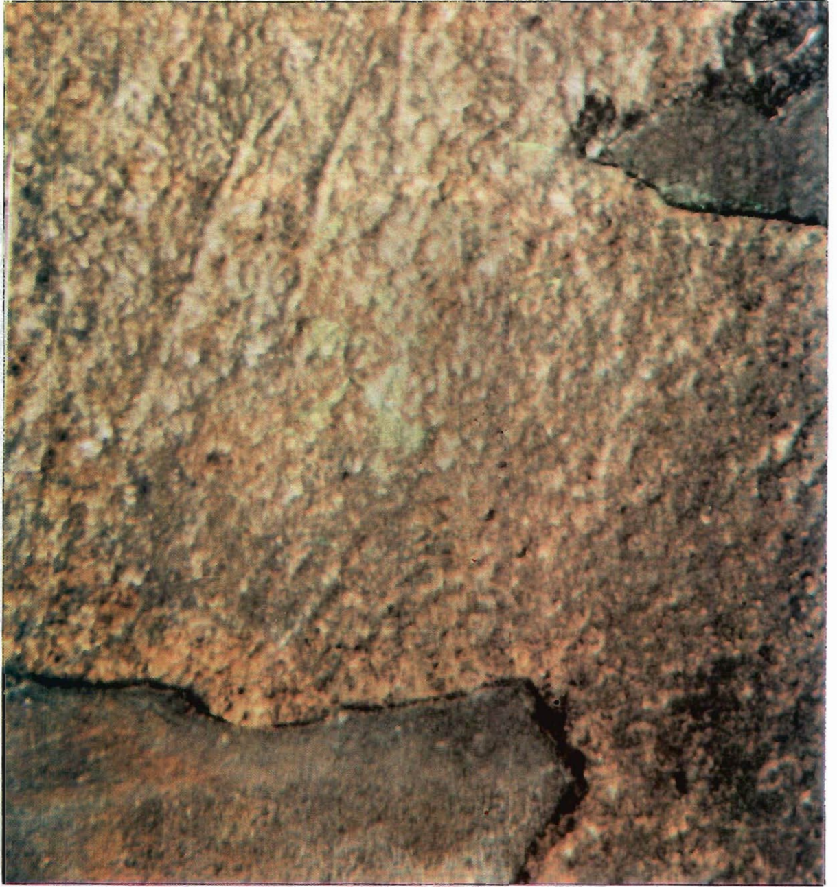
شكل (4) : - رواسب رقيقة ولاصقة على سطح الانابيب الداخلية والخارجية
